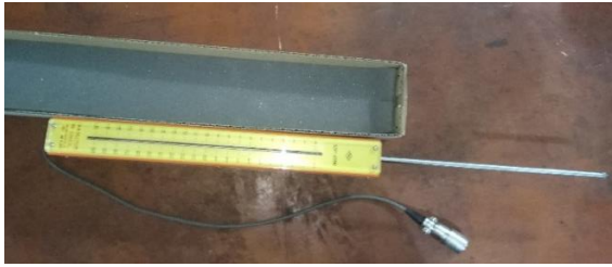
Gambar 2.3 Alat Pengukur Perpindahan ( LVDT )
